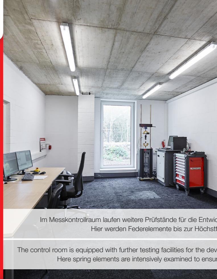
Im Messkontrollraum laufen weitere Prüfstände für die Entwicklung und Dauerlauf der Gabel- sowie Federbeinprodukte. Hier werden Federelemente bis zur Höchsttemperatur intensiv auf Funktion getestet.
